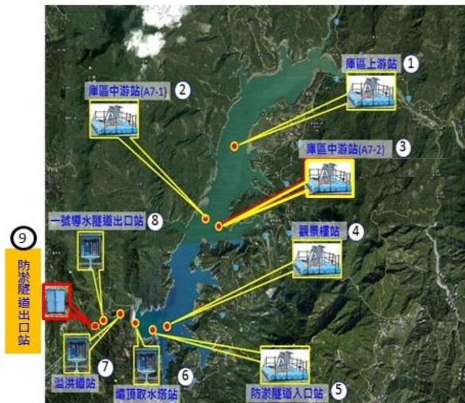
圖摘-1 庫區自動泥砂濃度觀測站
