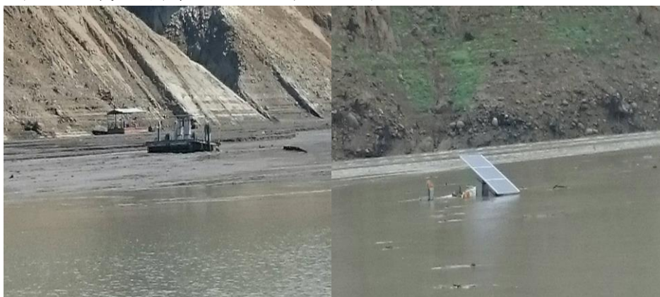
圖摘-3 中游 1 站觀測站遭遇泥流沖刷導致被淹埋
